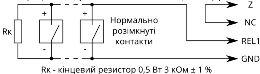
Рисунок 2.5 – Схема включення двопровідних сповіщувачів з нормально розімкнутими
