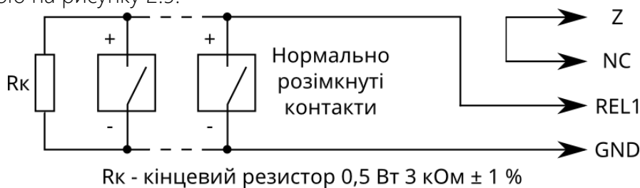
Рисунок 2.5 – Схема включення двопровідних сповіщувачів з нормально розімкнутими контактами
