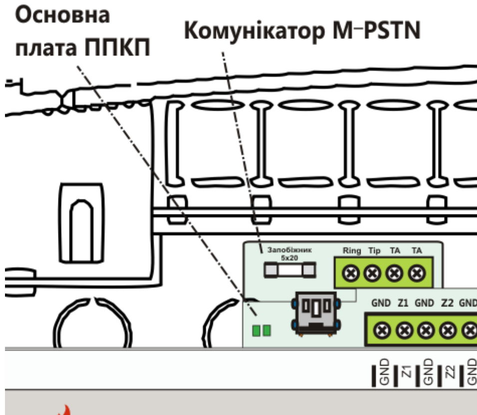
Рисунок 16 – ППКП з встановленим комунікатором М-PSTN
